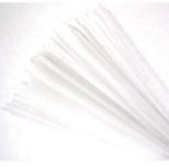
ポリプロピレンより硬く、耐摩耗性に優れている。濃塩酸、硫酸、硝酸に殆ど影響を受けない。溶融点260°C、使用限界140°C。
