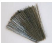
アクリル纖維に硫化銅を混入した導電性纖維で、静電気除去と除塵効果大である。
