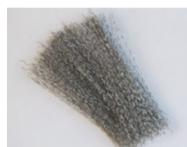
酸・アルカリ・熱に強く、硬鋼線に比べ錆が発生せず折損が少ない。ただし、SUS304はブラシ材に加工する工程で若干磁性を帯びるが、SUS316は磁性を有しない。ヨリ線もある。
