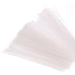
化学繊維の中では耐摩耗性、弾力性、柔軟性に優れ、耐久性は抜群である。アルカリには殆ど影響を受けない。一般溶剤(アルコール、ガソリン、ベンゼン等)には不溶解。濃塩酸、濃硫酸、濃硝酸で一部分解を伴って溶解。フェノール類、濃壱酸に溶解。氷酢酸に膨潤。使用限界は約80°C。
