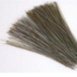
超耐熱繊維で、反発性と腰が強く、対摩耗性に優れている。10%苛性ソーダー、40%硫酸で強度は殆ど低下しない。静電気の発生や汚れが付着しにくい。
