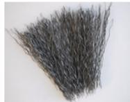
冷間引延により硬度を出したもので、広く工業用に使用される。しかし錆が発生したり連続使用したりすると金属疲労を起こす。
