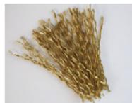
メッキ線（単線）を數本燃り加工したもの。ヨリ線は単線と比べ、毛切れが発生しにくいくこと、研削量が良好なこと、研削が荒くないことが確認できます。ヨリとはより合わせてあることで、毛腰をし毛切れ、毛くせが付きにくくなっています。
