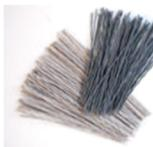
ナイロン材の中に砥粒（酸化アルミナ、シリコンカーバイト又はダイヤモンドパウダー）を混入しフィラメントとして加工した線材であり、研磨力に優れています。その他の特性は殆どナイロンと同じである。
