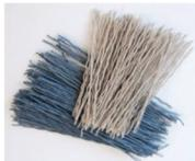
ナイロン材の中に砥粒（酸化アルミナ、シリコンカーバイト又はダイヤモンドパウダー）を混入しフィラメントとして加工した線材であり、研磨力に優れています。その他の特性は殆どナイロンと同じである。
